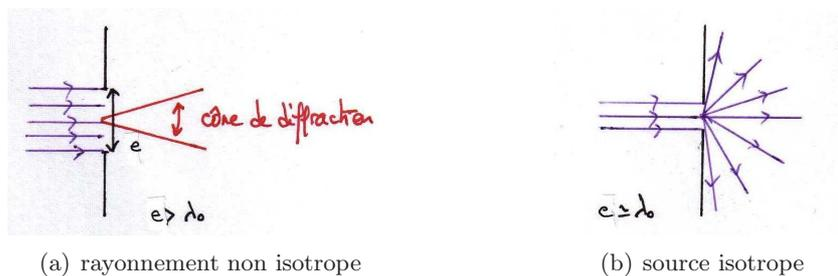
FIGURE 2 – Cône de diffraction en fonction de la taille  $e$  du motif diffractant
