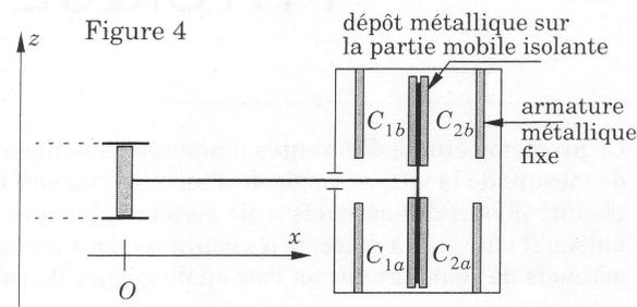
On rappelle que, si l'on néglige les effets de bord, la capacité d'un condensateur plan est donnée par  $C = \epsilon S / e$ , où  $S$  est la surface des armatures en regard et  $e$  la distance séparant ces armatures.
