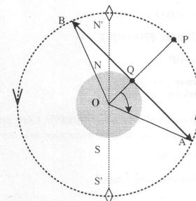
Fig. 1 : Satellite P, point Q et ligne des horizons AB. Le plan orbital représenté est dit polaire (la ligne des pôles est N'SNS'). L'angle est dit ancillaire.
