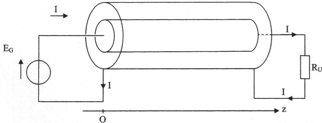
Le conducteur intérieur constitue le conducteur aller du courant électrique d'intensité  $I$ .
