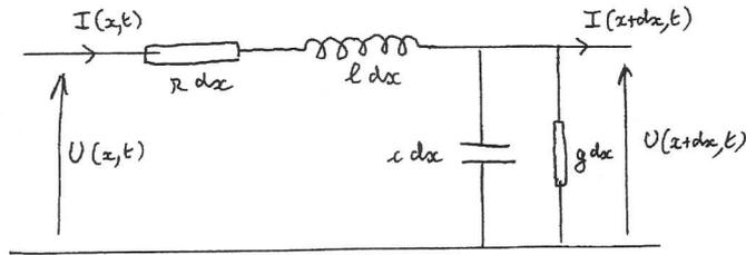
On modélise une portion de longueur  $dx$  de ligne électrique à haute fréquence par la figure ci-dessus, où  $r$ ,  $l$ ,  $c$  et  $g$  désignent respectivement une résistance, une inductance, une capacité et une conductance linéiques. Trouver deux équations aux dérivées partielles vérifiées par la tension  $U(x,t)$  et par l'intensité  $I(x,t)$ .
