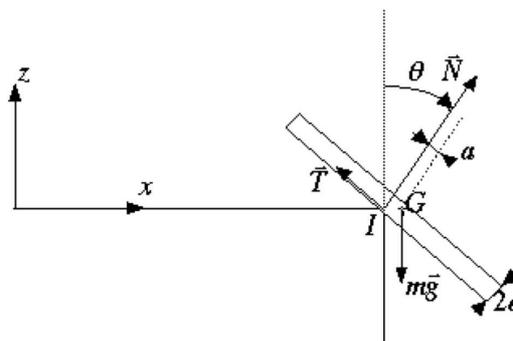
Déterminer  $\dot{\theta}$  et  $\ddot{\theta}$  en fonction de  $\theta$  et des constantes du problème. Même question pour  $N$  et  $T$ . Tracer les graphes donnant  $N$  et  $T$  en fonction de  $\theta$ . La tartine décolle-t-elle de la table avant de glisser ou l'inverse ?
