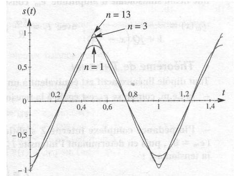
(d) Reconstruction d'un signal triangulaire par superposition de ses  $n$  premiers harmoniques ( $n = 1, 3$  et  $13$ )
