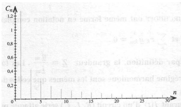
(a) Spectre de fréquence d'un signal carré. Les amplitudes des raies sont inversement proportionnelles aux nombres impairs successifs.
