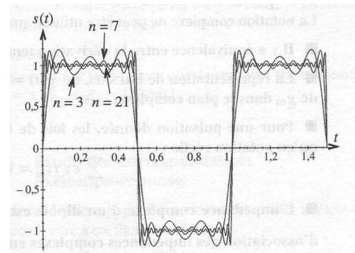
(b) Reconstruction d'un signal carré par superposition des ses  $n$  premiers harmoniques ( $n = 3, 7$  et  $21$ )
